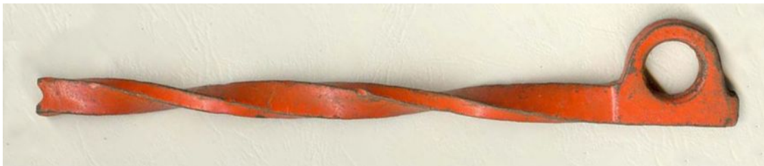
Рис.1. - кованный винтообразный крюк длиной до 25 см., ширина винтовой части – 15 мм. В альпинистской практике подобные крючья еще существовали в послевоенное время.
