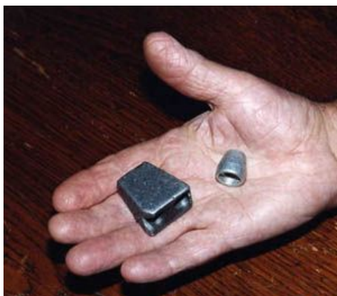
Сравнительные размеры закладок «Acorn» (справа на ладони) и «Моас» ( фото by Stéphane Pennequin)
